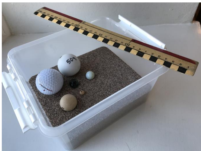
Fig. 1. Den utrustning studenterna har till sitt förfogande för att besvara frågan "Hur stor blir kratern då ett sfäriskt objekt släpps ner i sand?".
