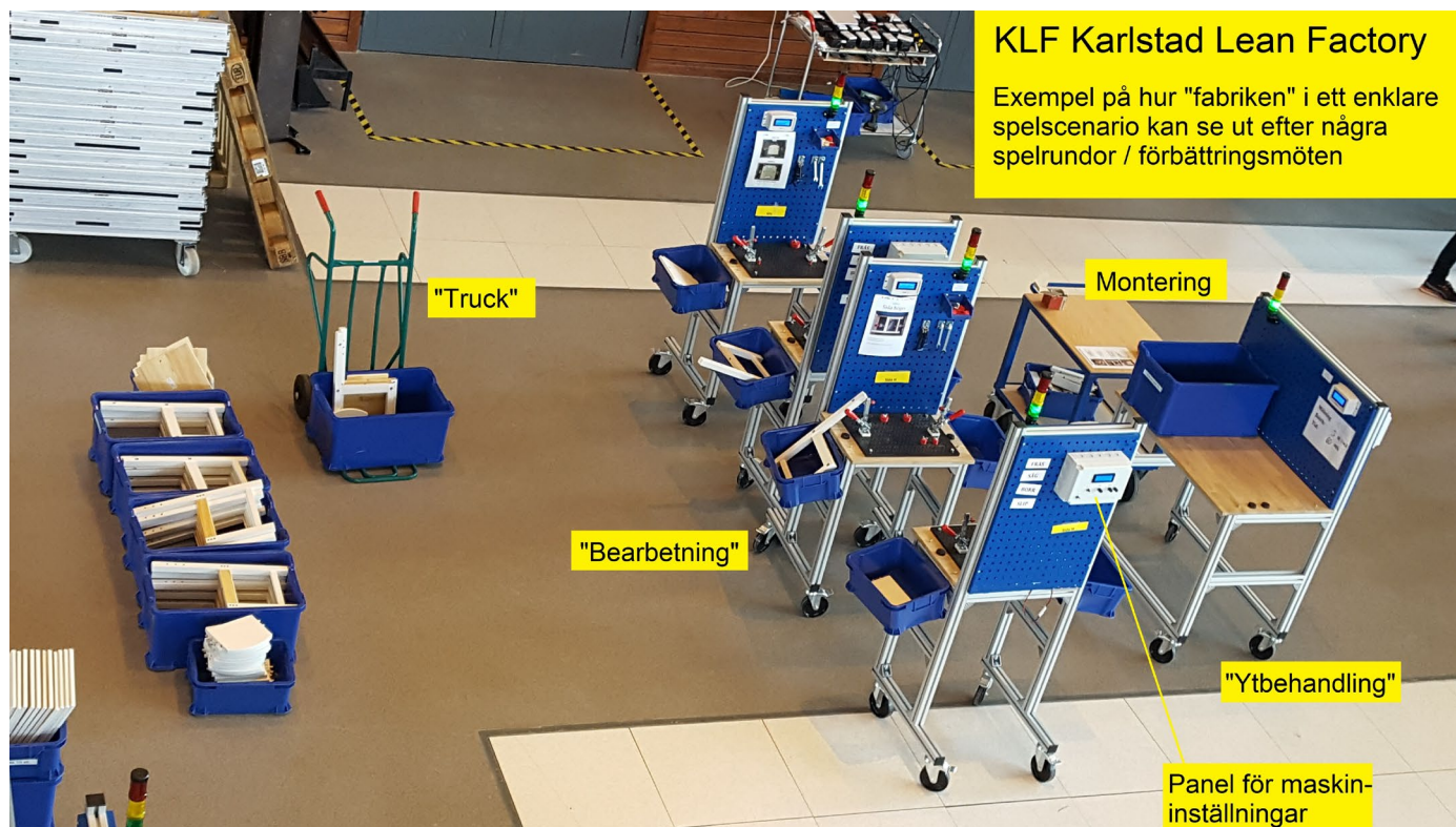
Figur 1. Exempel på konfiguration av produktionslinan efter några spelrundor och förbättringsmöten i ett enklare spelscenario (enbart vita stolar och obegränsad efterfråga, inga maskinstörningar).
